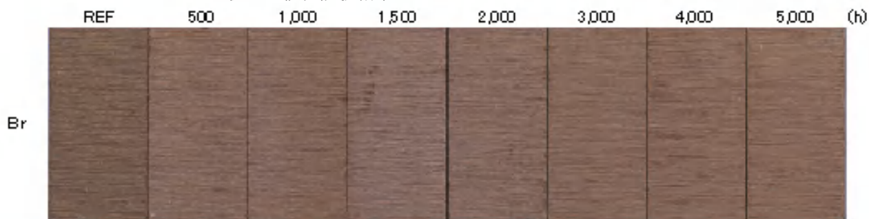
サンシャインウェザーメーター促進耐候性試験結果
